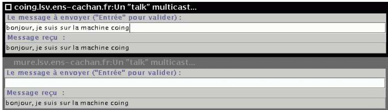
FIG. 2 – Rendu visuel de la commande java TalkMulticast lancée sur deux machines distinctes
