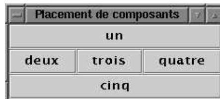
FIG. 5.1 – Rendu visuel de la classe PositionnementDesComposants en utilisant un gestionnaire de placement de composants de type BorderLayout .
