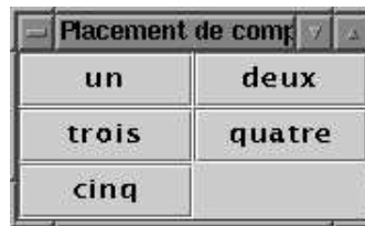
FIG. 5.4 – Rendu visuel de la classe PositionnementDesComposants en utilisant un gestionnaire de placement de composants de type GridLayout sur 3 rangées de 2 colonnes.
